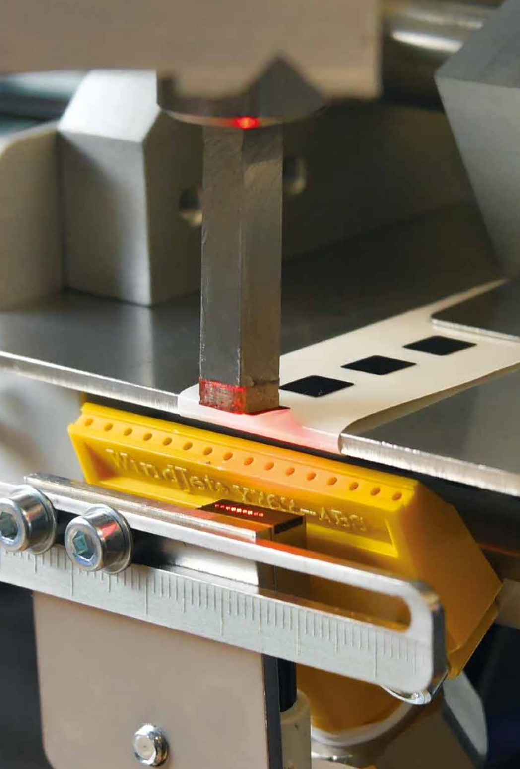
Präzisionsstempel zur exakten Applikation kleinster Etiketten
