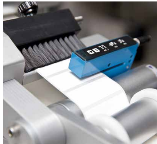
Abstandsprüfung zur genauen Positionierung
